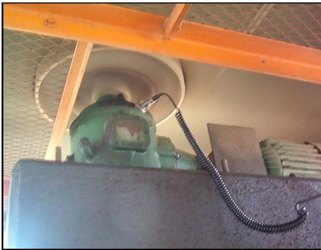
Figure 1: Vista del ventilador con el sensor de velocidad de rotación del rotor se utilizó una lámpara
