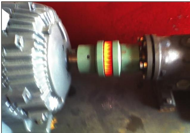
Figure 1: Acople entre el motor y la bomba
